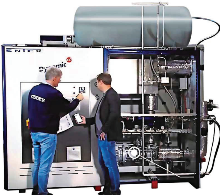
Entex war das erste Unternehmen weltweit, das ein 420°C Temperiergerät gebaut hat. So hohe Temperaturen werden zum Beispiel bei der Einarbeitung von Glas- oder Kohlefasern im Composite-Bereich benötigt. Foto: Entex
