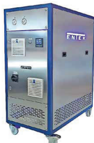
Für hohe Energieeffizienz sind die Temperiergeräte nicht einzeln elektrisch beheizt, sondern arbeiten mit einem gasbefeuerten Kessel und Mischkreisen vor den Temperiergeräten mit Wasser oder Thermalöl. Foto: Entex
