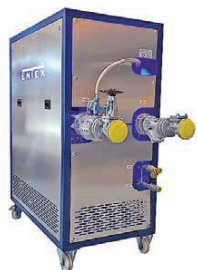
Die Temperiergeräte von Entex sind exakt auf die Anforderungen der eigenen Planetwalzenextruder abgestimmt, kommen inzwischen aber auch bei anderen Anwendungen zum Einsatz. Foto: Entex
